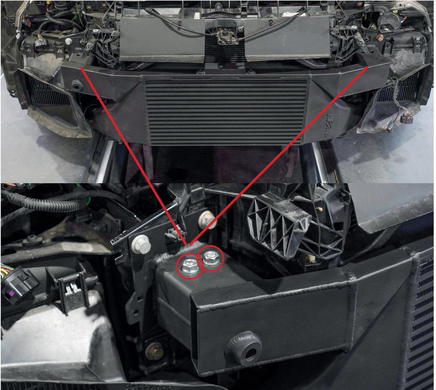
5. Montieren Sie die originalen Ladeluftkühler Führungen nach Herstellervorgabe.
