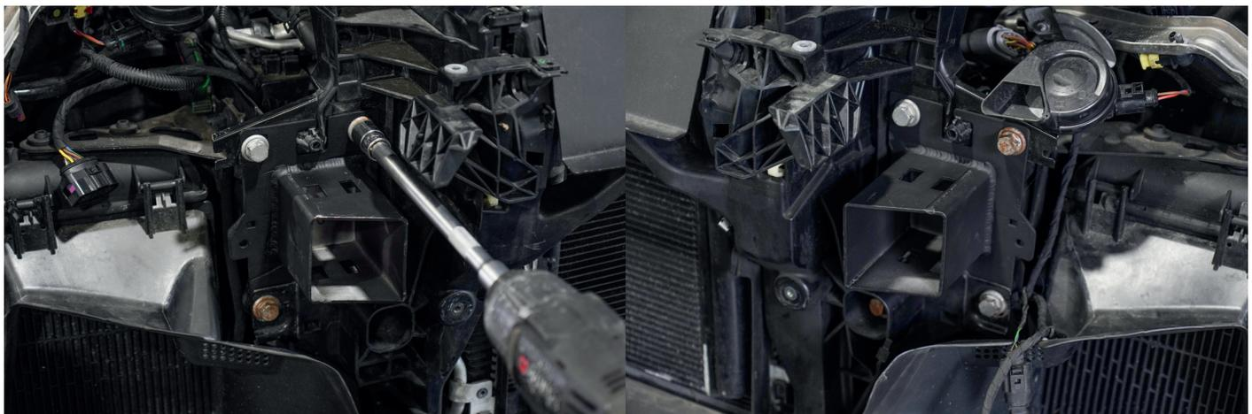
4. Setzen Sie den HF Series Ladeluftkühler, auf die Halterplatten und fixieren diesen mit den mitgelieferten Schrauben und Muttern, an beiden Seiten.
