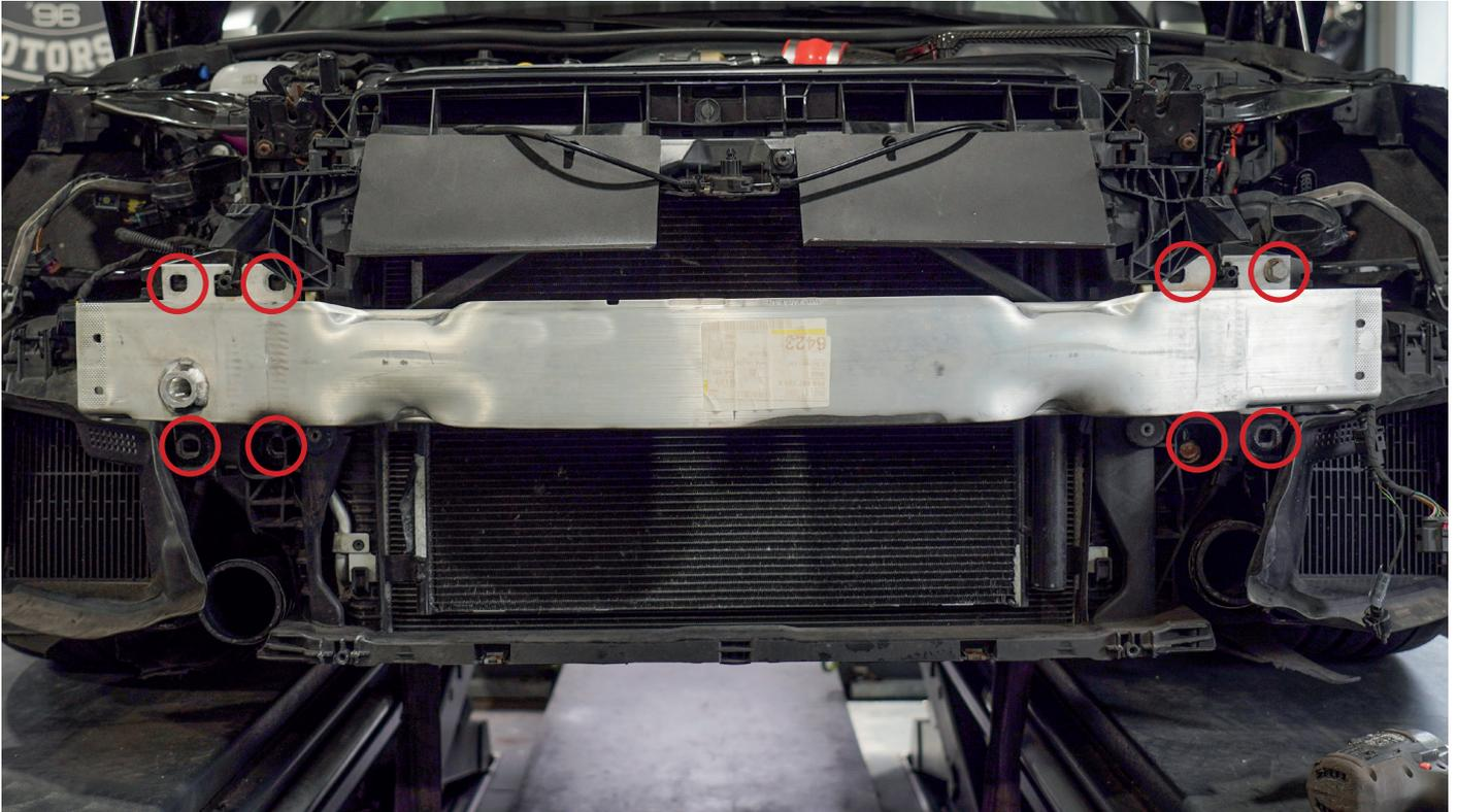
3. Montieren Sie die mitgelieferten Halterplatten, an den Positionen des Prallträgers, mittels 16er Nuss und den zuvor entfernten Schrauben.
