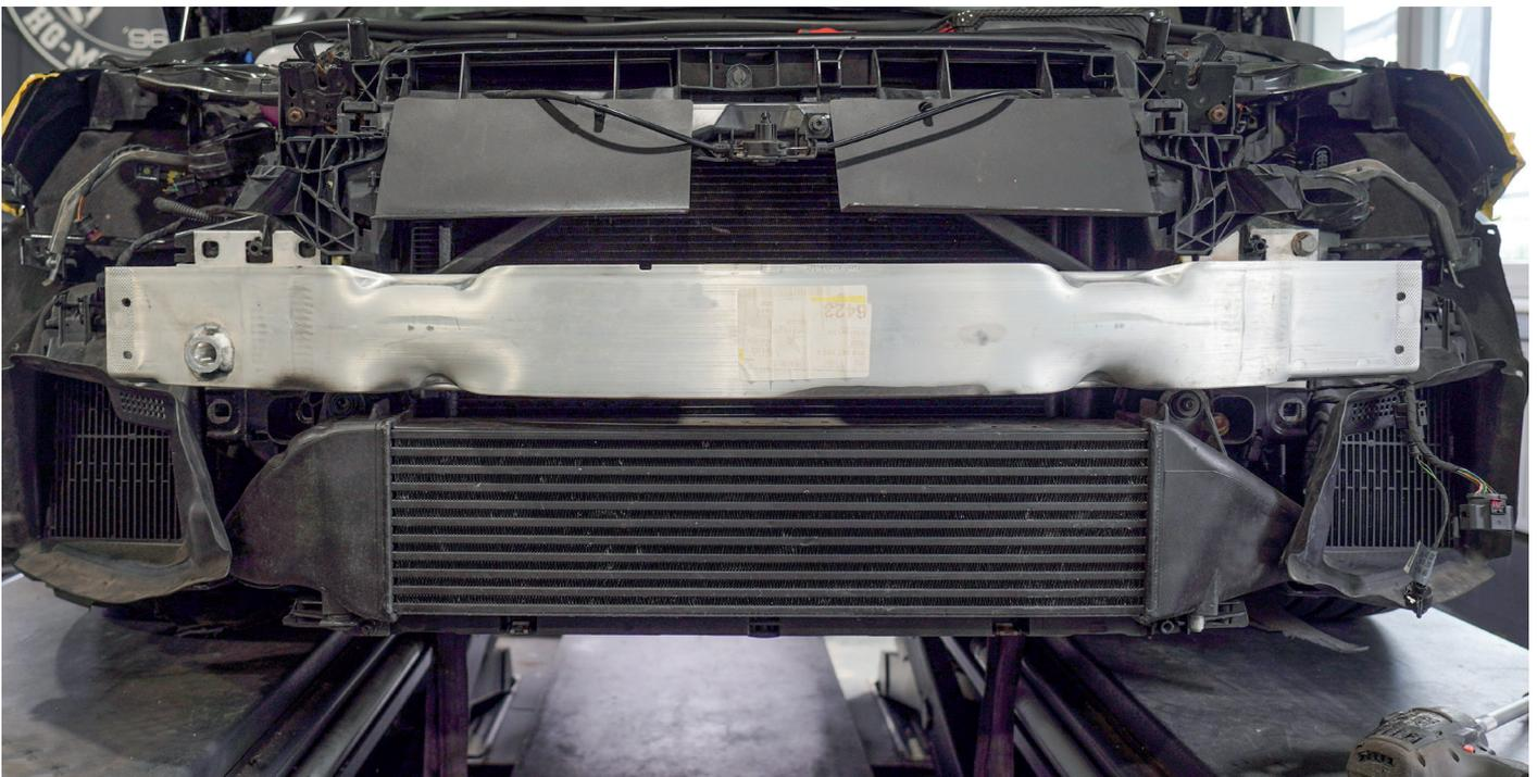
2. Demontieren Sie den OEM Ladeluftkühler und den OEM Prallträger(16er Nuss), laut Herstellervorgabe.
